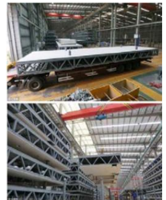
Fig.28 Fábrica Central BSB, seção de piso
