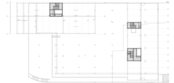
Fig.34 Núcleos rígidos de betão armado
