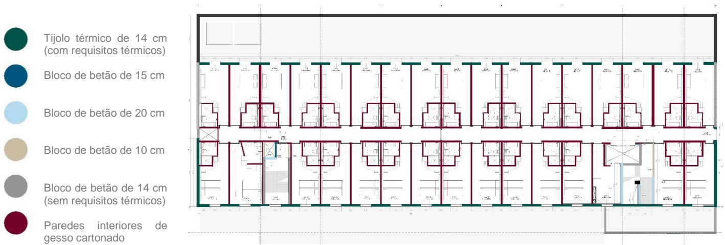
Fig.47 Planta de Paredes, CE 2, piso 1
